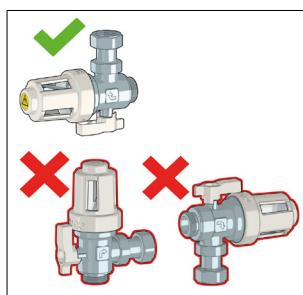
Separator nečistoće uvek mora da bude instaliran horizontalno.
