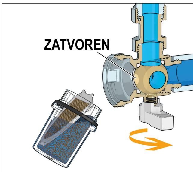
Zauzdavljeni ventil je posebno projektovan tako da pre čišćenja unutrašnjih elemenata treba samo ispuštiti vodu koja se nalazi u separatoru nečistoće.
