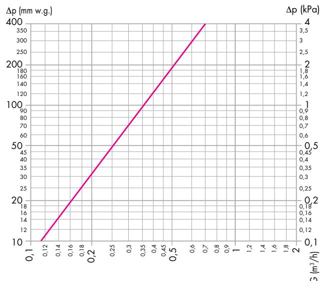
**Kv (sa čistim filterom): 3,55 m³/h**
