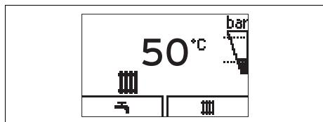
Osnovni prikaz prikazuje aktuelan status proizvoda. Ako pritisnete taster, onda će na displeju biti prikazana aktivirana funkcija.
